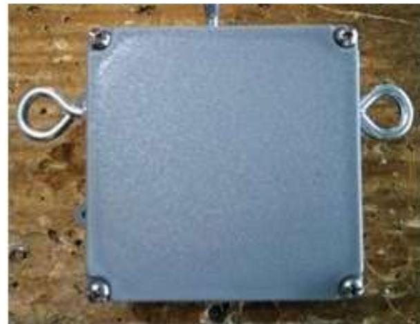
В конструкции использовались три винта с проушиной из нержавеющей стали и водонепроницаемая коробка, аналогичная большинству конструкций. Одной из особенностей являются отдельные латунные болты для лучшего радиочастотного соединения.
